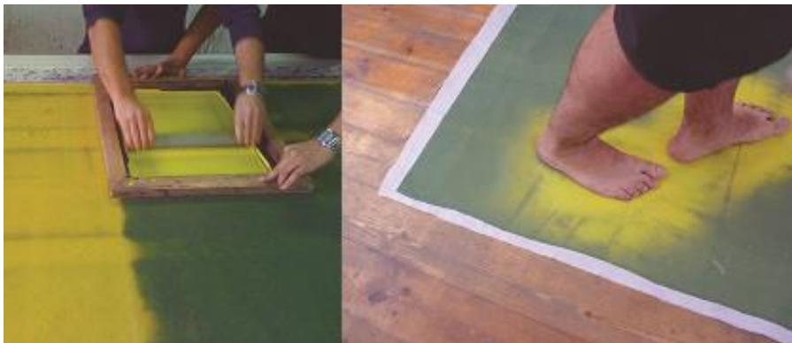
**Figura 2.** *Proceso de aplicación de una tinta termosensible a una superficie textil – alfombra-, que cambia su color de verde a amarillo al entrar en contacto con el calor corporal de los pies que la pisan.*
