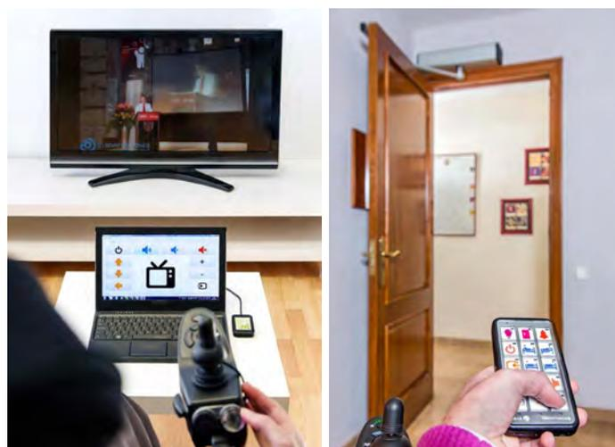
Figura 9. Ejemplos de control de entorno. 1) Control del televisor desde un ordenador con el sistema BJ; 2) Control de los accesos del domicilio desde un mando BJ Control Pro
