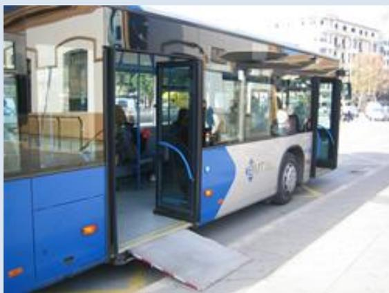
*Como se puede observar en la imagen, la rampa facilita el acceso al vehículo a personas con discapacidad en silla de ruedas. De esta forma se supera el cambio de plano entre la acera y el vehículo.*
