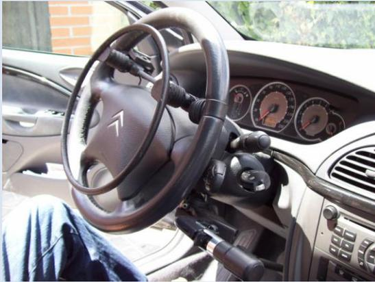
*El vehículo utilizado para realizar uno de los trayectos analizados dispone de una adaptación para permitir su uso por una persona con discapacidad física en silla de ruedas.*
