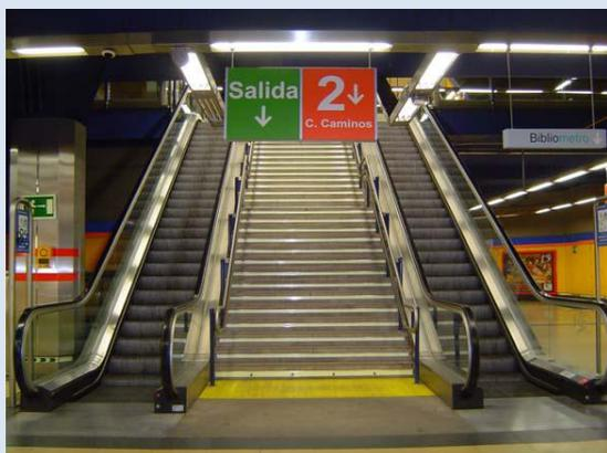
La señalización en el pavimento a través de una textura distinta y un color que de gran contraste como el amarillo advierte de la proximidad de una escalera.
