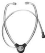
Permite oír el sonido del audifono para realizar controles que nos ayudan a determinar rápidamente si el audifono se oye mal para proceder a su reparación.
