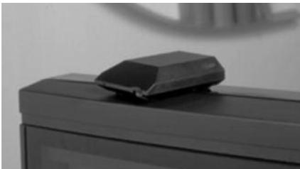
Pequeño amplificador de inducción magnética que además recibe las señales de aviso del sistema Puzzle y las emite a través del anillo inductivo, garantizando su escucha por aquellas personas que estén con su prótesis en posición T dentro de su radio de acción (50m2).
