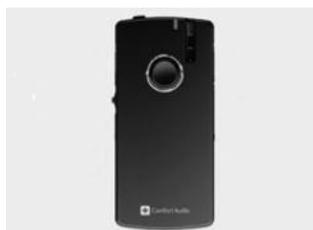
El DM-20 es un pequeño transmisor con un micrófono y receptor incorporado y un mezclador para ambos. El sonido se puede recibir en otro micrófono Digisystem y enviarse a uno o más receptores del sistema.
